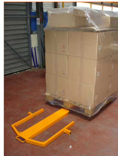
CALPACK element pozycjonujący umożliwiający podwinięcie folii pod paletę
